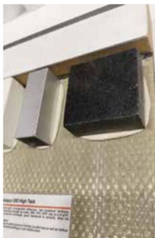
Vždy je nezbytné vybírat lepidla, která jsou schopna lepit sklolaminát na rubové straně dlaždic.
