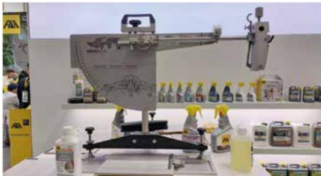
Bezpečnost pohybu osob je nezbytná. Fila představovala kyvadlo (Pendulum) pro měření smykového tření výkyvem kyvadla.
