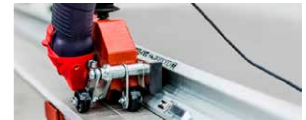
Bild 11 Schneidegerät mit Führungsschiene
